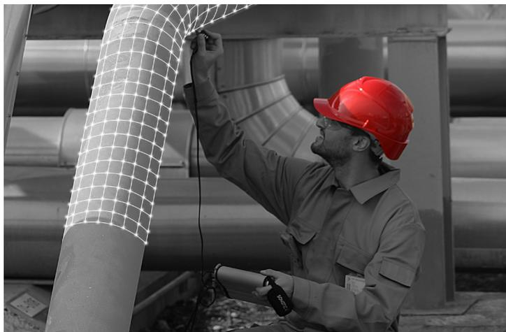
Effiziente und zuverlässige Datenerfassung mit farbcodierter Visualisierung des Prüfrasters
